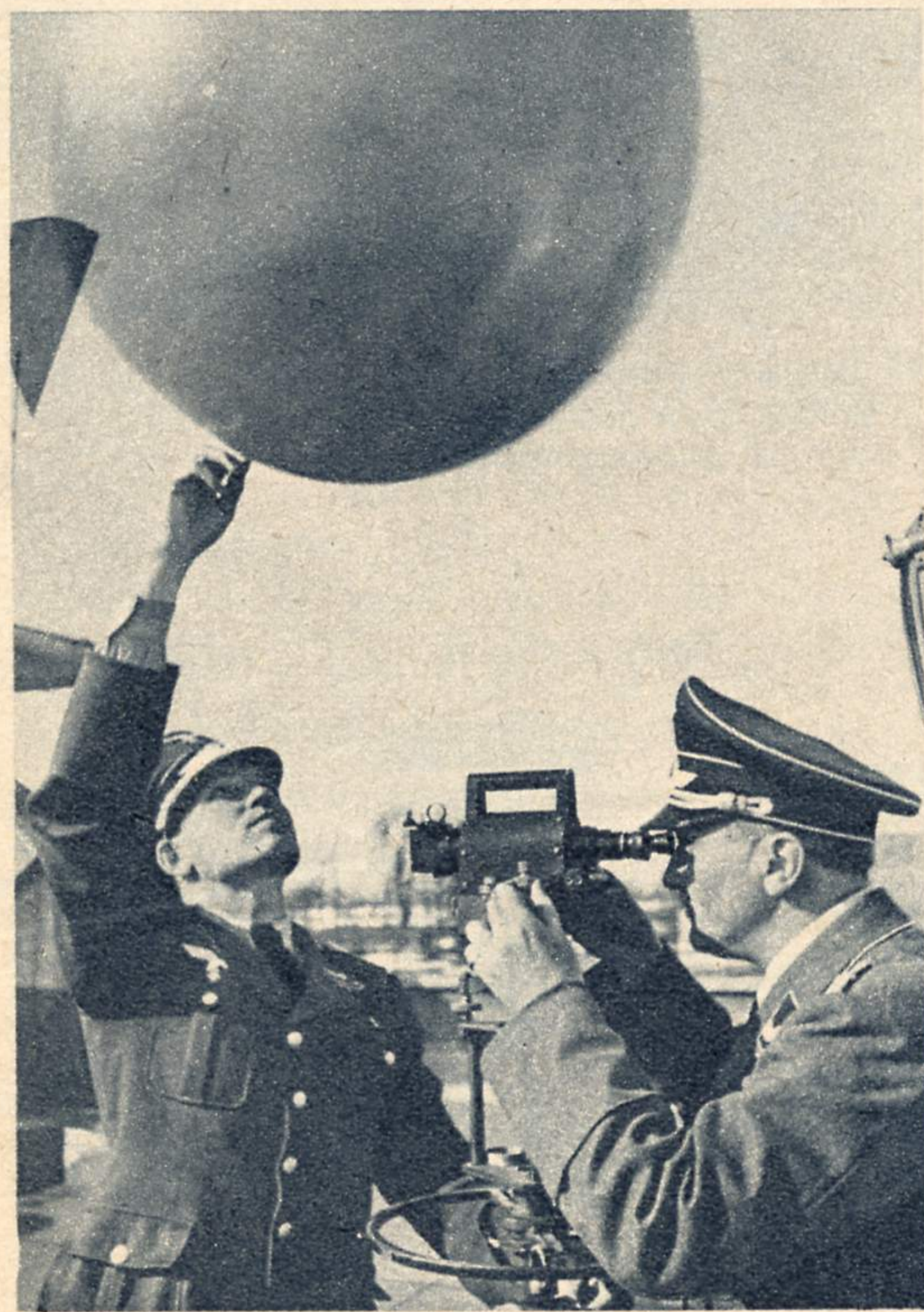
Wenn sie auch zum Bodenpersonal gehören, so ist ihr Reich doch der unermeßliche Luftraum. Die Meteorologen versorgen die Besatzungen mit Wettermeldungen. Hier lassen sie einen Pilotballon auf, um Richtung und Stärke des Windes in den verschiedenen Höhen mit dem Theodoliten zu messen
